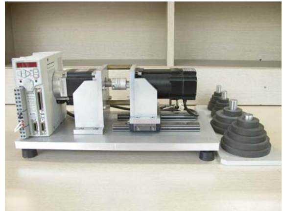
그림 12 관성 추정/부하 토크 추정을 위한 서보 시스템 및 관성 부하
