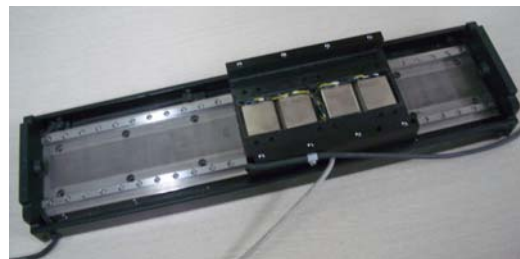
그림 5 시험 대상 LHSM의 외관 Fig. 5 Photograph of prototype LHSM under test
